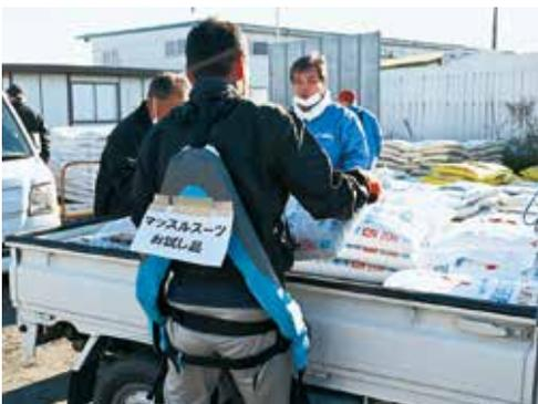
アシストスーツ装着して積み込み
