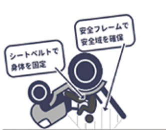
●転落・転倒時に、安全キャブ・フレームは安全域を確保してくれます。 ●安全域にとどまるためには、シートベルトの着用が必要です。 出典：農林水産省ホームページより
