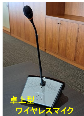
役員会議室専用マイク(最大20台まで) ※持運び可能 20台まで同時使用可
